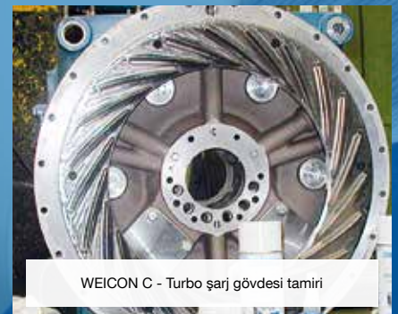
Kavitasyon hasarı ve çürüme nedeniyle ağır hasarı yüksek alaşimli çelik Türbin.
